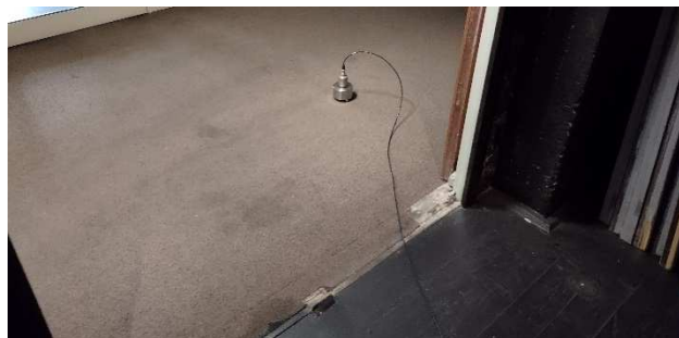
Obrázok 3.2 – Pripevnenie akcelerometrov ku kolmým nosným stenám a na podlahu.
